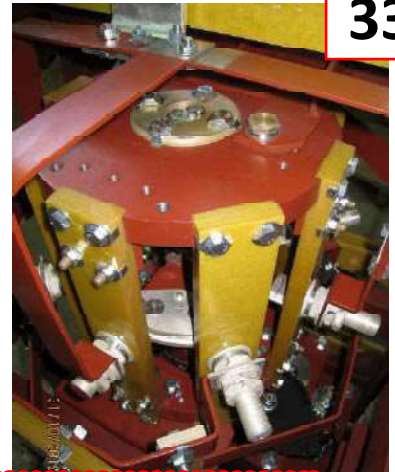
Однофазные контакторы для переключающих устройств РНОА-35/1000ВУ1, переключаемые без возбуждения
